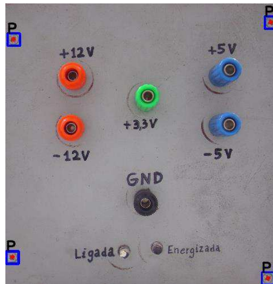
Figura 34. Imagem resultante da detecção de parafusos via template matching na face frontal da fonte de bancada.
