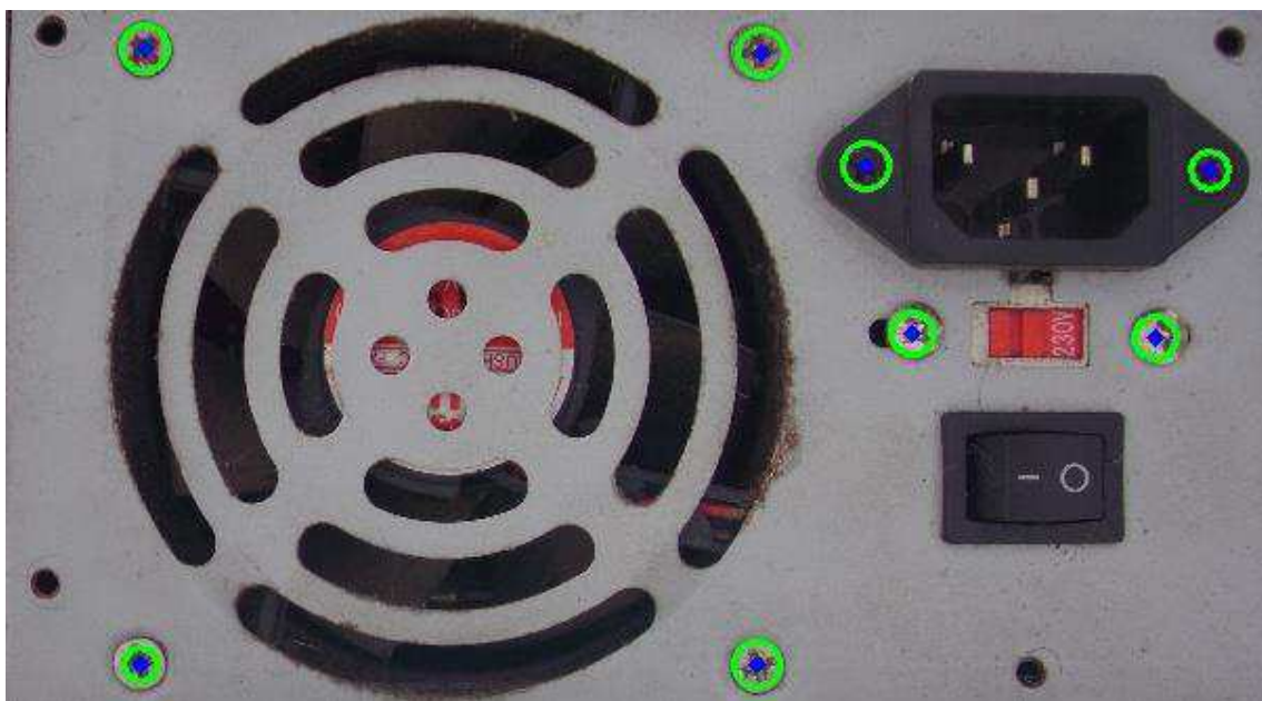
Figura 37. Imagem resultante da detecção de parafusos via detecção de círculos na face lateral da fonte de bancada.
