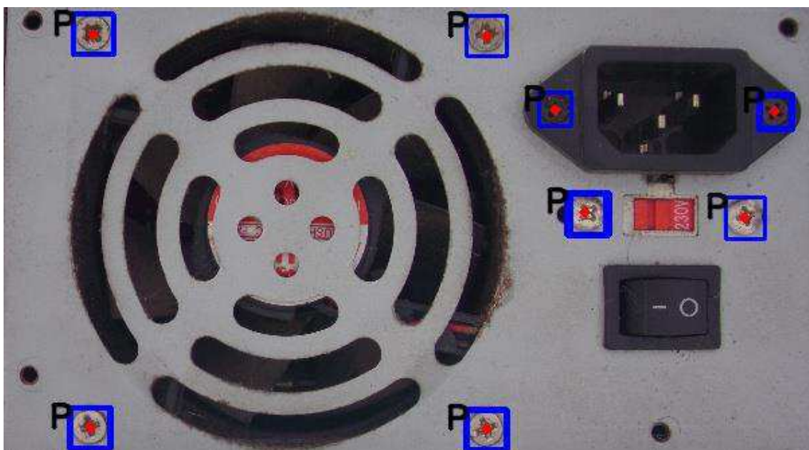
Figura 38. Imagem resultante da detecção de parafusos via template matching na face lateral da fonte de bancada.
