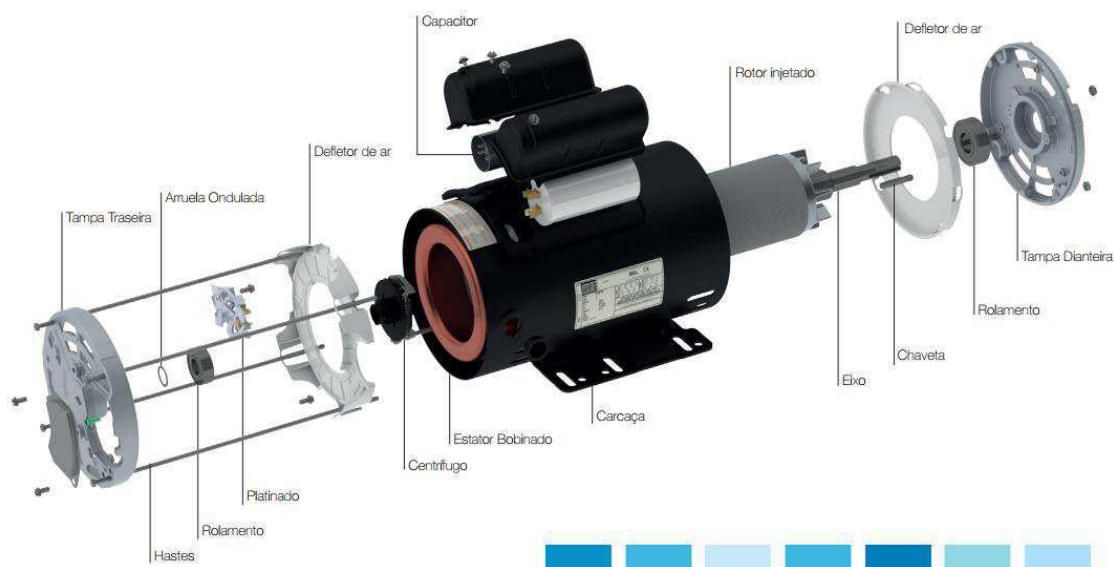
Figura 8: Componentes de um motor elétrico de indução monofásico.
