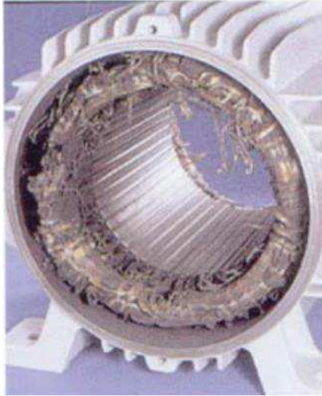
Figura 13: Enrolamento danificado por sobrecarga
