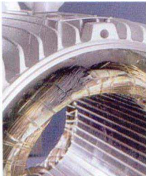
Figura 11: Curto circuito entre fases.
