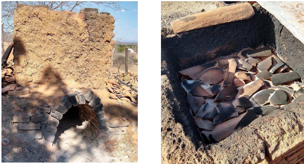
Figura 6 – Forno com abertura no topo, localizado na parte externa da cerâmica artesanal
