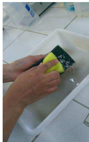
Figura 9: Etapas processo lavagem Material. (a) material em uma bandeja com água (b) movimentos circulares criando uma fricção com ajuda de esponjas
