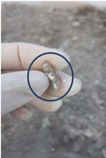
Figura 12: Argila grudada no material 4,75 mm
