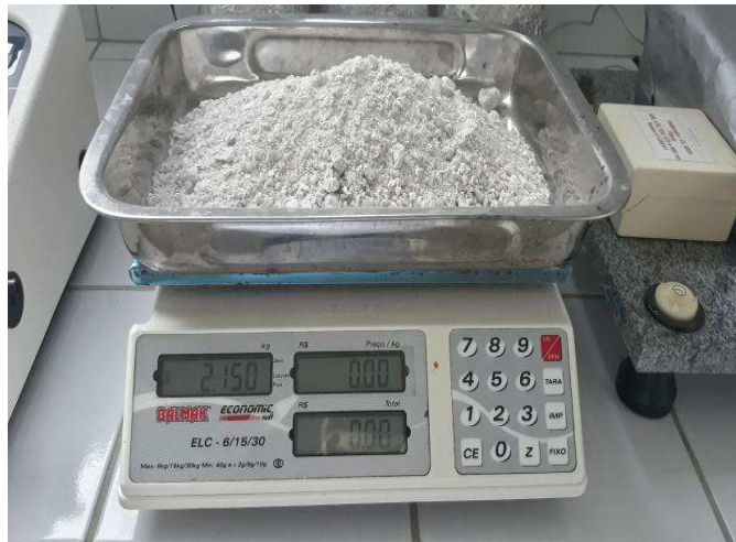
Figura 5: pesagem amostra do rejeito de caulim
