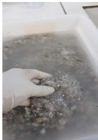
Figura 9: Etapas processo lavagem Material. (a) material em uma bandeja com água (b) movimentos circulares criando uma fricção com ajuda de esponjas
