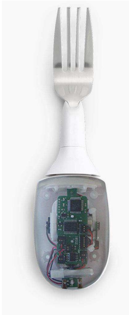
Figura 4 - Circuito contido no Liftware Steady .
