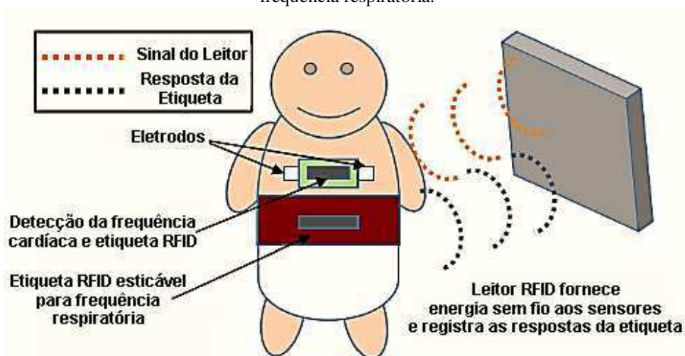
Figura 8 – Monitor infantil RFID com sensores RFID separados para monitoramento da frequência cardíaca e da frequência respiratória.
