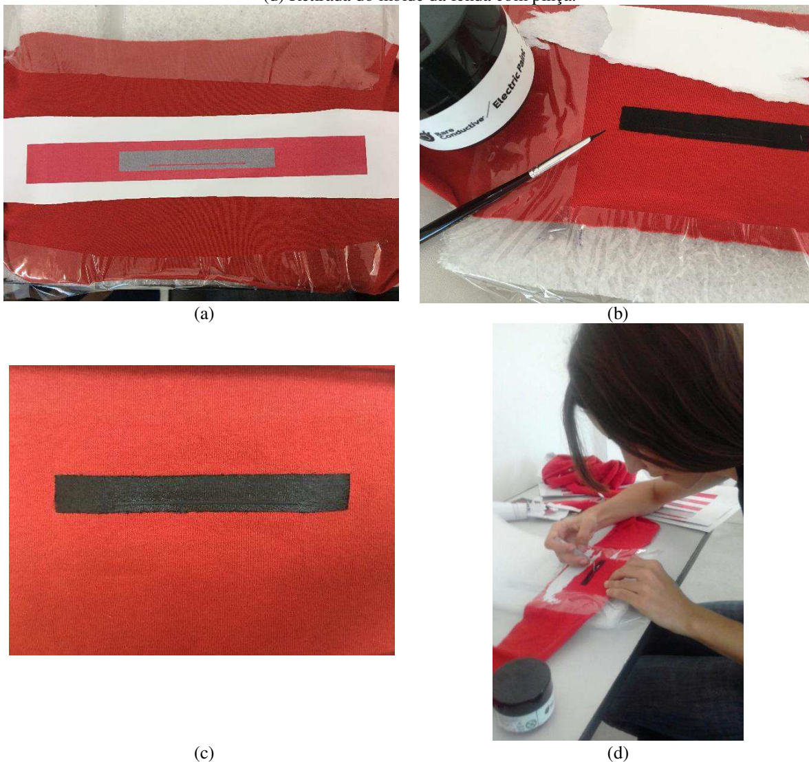
Figura 28 – Passos da confecção correta da antena. (a) Fixação do tecido na espuma de polietileno e colagem do adesivo. (b) e (c) Após pintura da região condutora com esponja e pincel mais fino, foi retirado o molde externo. (d) Retirada do molde da fenda com pinça.
