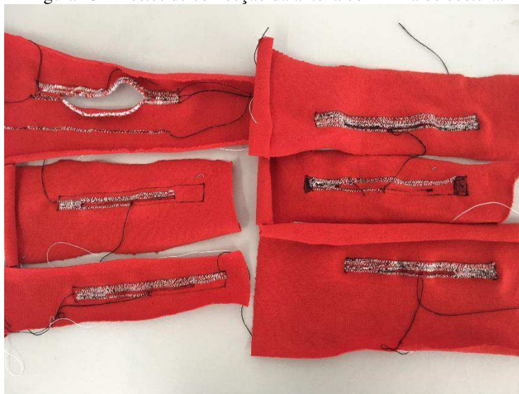
Figura 23 – Testes de confecção da antena com linha de costura.
