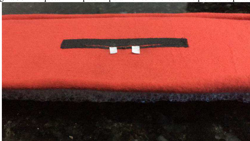
Figura 30 – Etiqueta RFID passiva para monitoramento da frequência respiratória.
