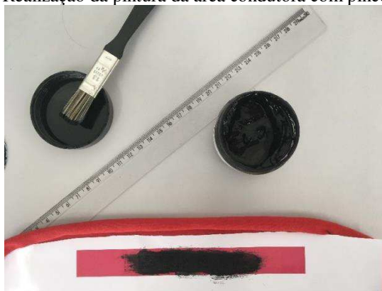
Figura 27 – Realização da pintura da área condutora com pincel mais largo.
