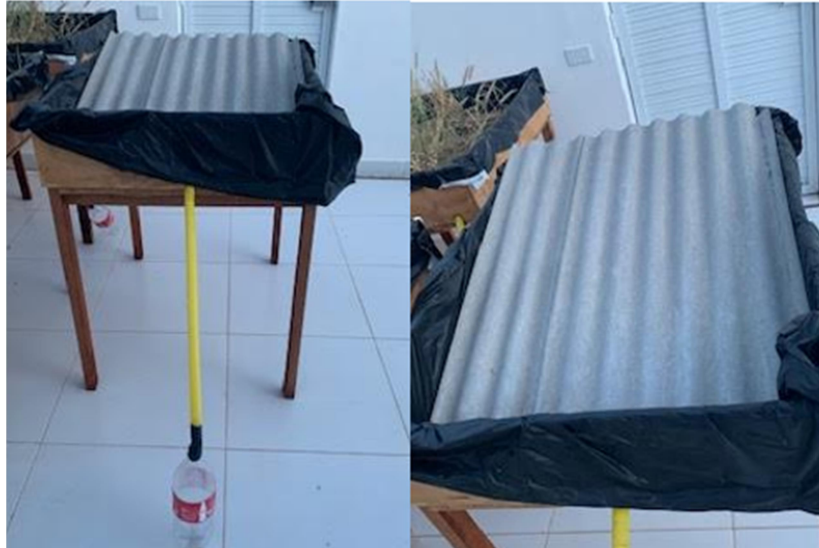
Figura 13: Protótipo com telha de fibrocimento.
