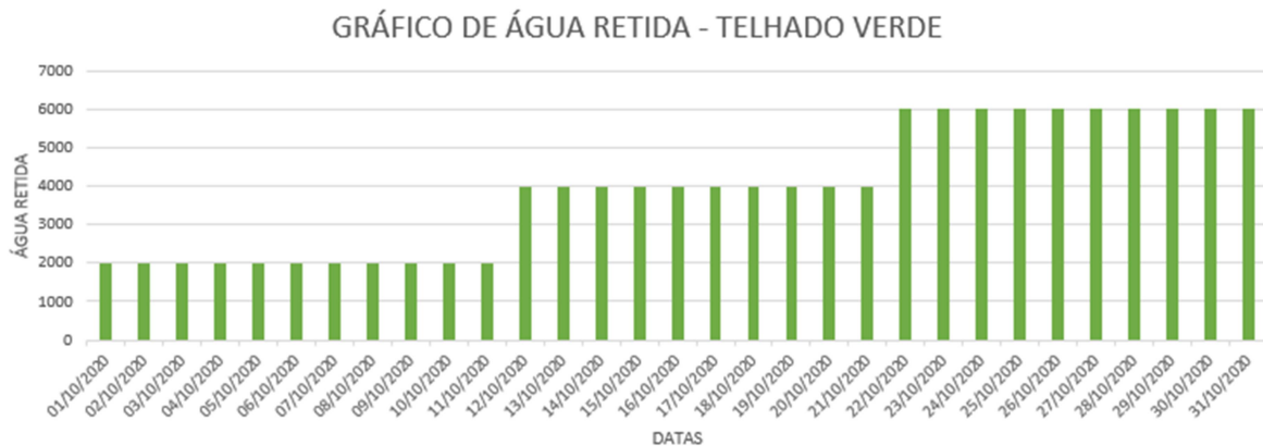
Figura 18: Gráfico da porcentagem de água retida do telhado verde.
