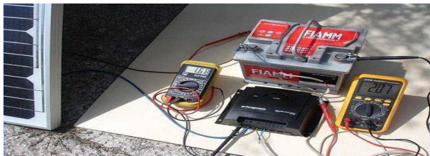
Figura 11: Controlador de carga em atuação no sistema.
