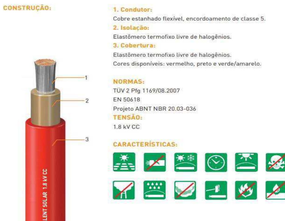
Figura 18: Cabo solar e especificações técnicas.
