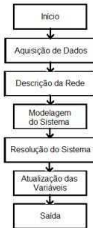
Figura 20: Fluxograma da análise de sensibilidade de tensão.
