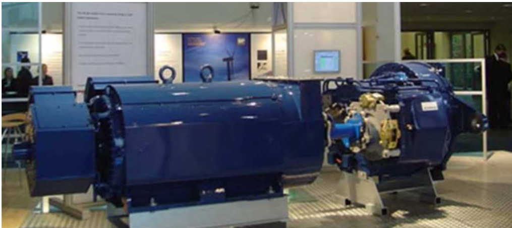
Figura 18 – Caixa de engrenagens conectada ao gerador
