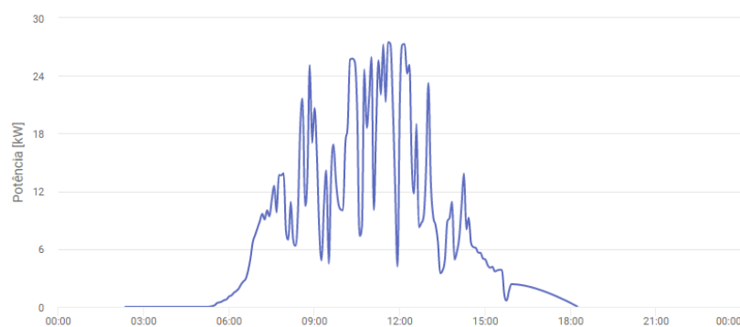
Figura 4 - Curva de potência gerada por hora do dia em um dia nublado
