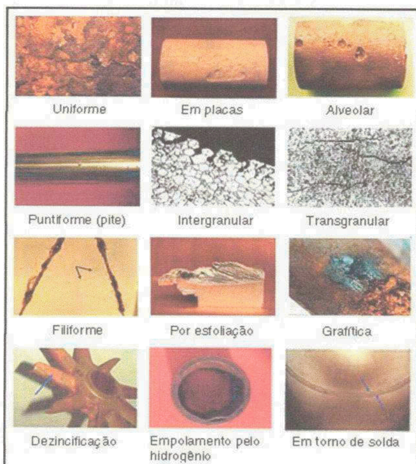
Figura 1. Formas de corrosão (PONTE, 2003).
