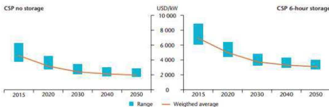
Figura 19 – Comparação e projeção de custo de capital entre uma planta heliotérmica sem armazenamento e com armazenamento de 6 horas.
