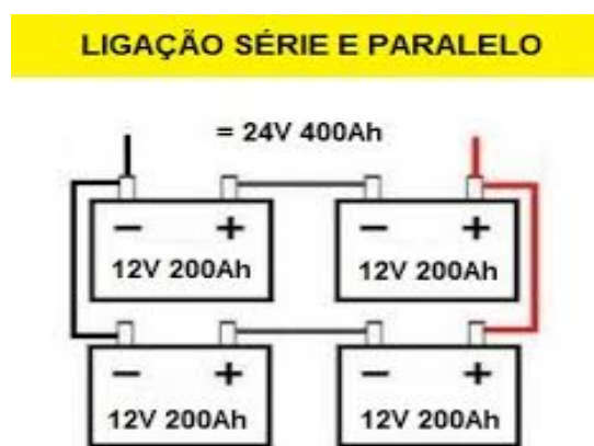
Figura 23: Esquema de ligação mista entre baterias
