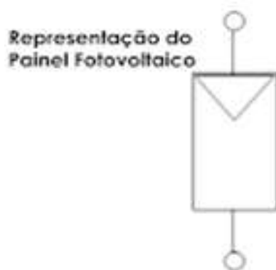
Figura 12: Representação do módulo fotovoltaico
