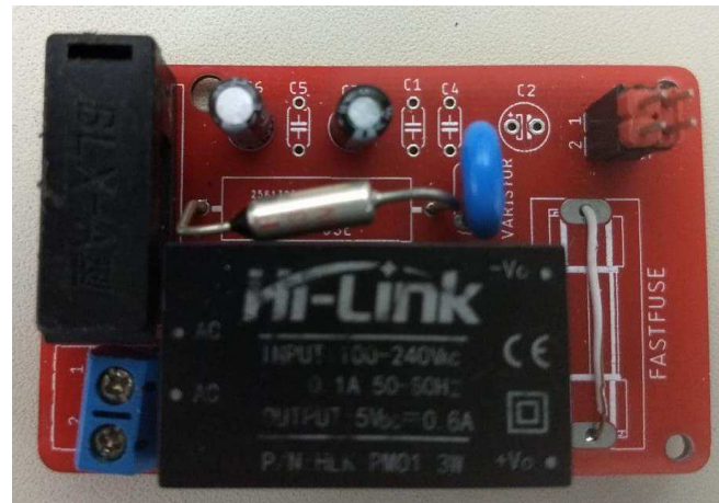
Figura 8: Unidade de alimentação montada
