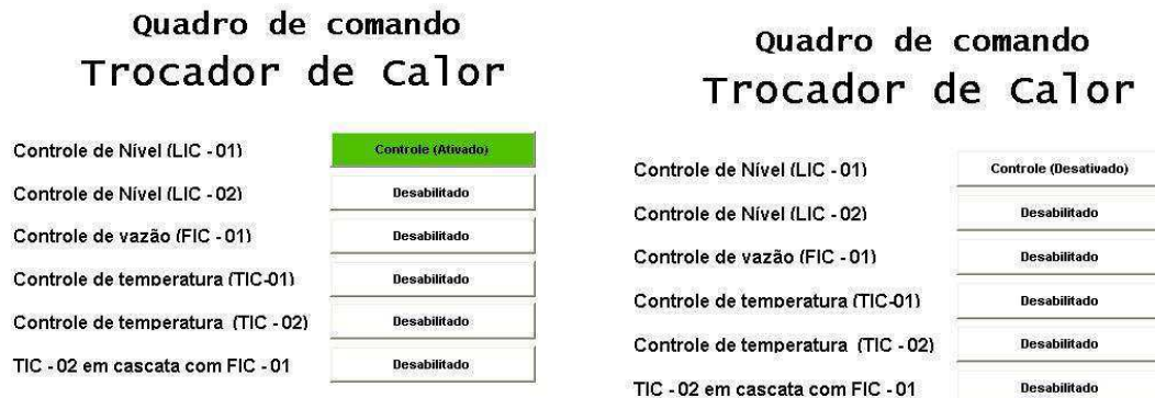
Figura 20: Quadro de comando ativado (direita) e desativado (esquerda)
