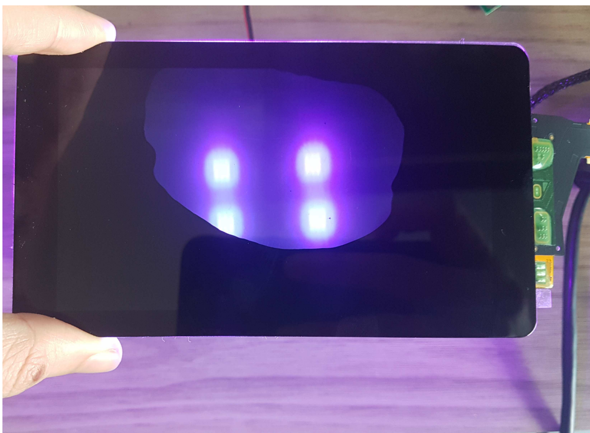
Figura 61 – Funcionamento da tela LCD 2K durante o processo de impressão 3D.
