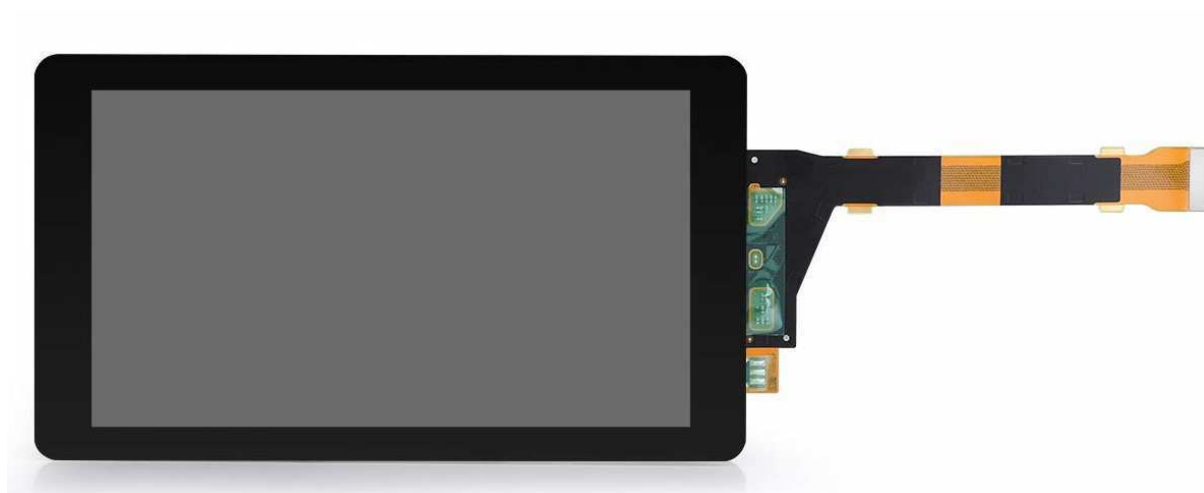
Figura 13 – Tela LCD utilizada para a projeção das camadas de impressão 3D.
