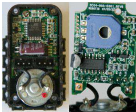
Figura 3 – Componentes internos do motor AX-12A
