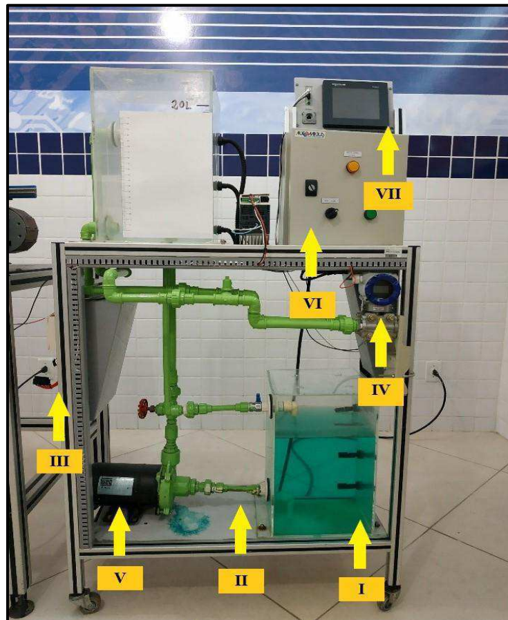
Figura 1 - Sistema de Controle de Nível
