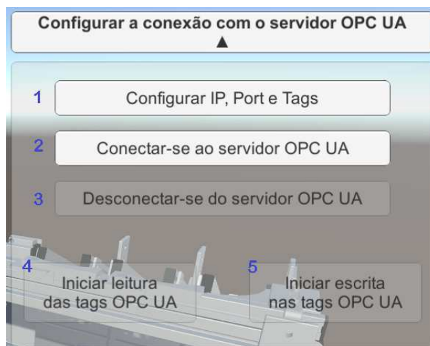
Figura 61 – Botões da aplicação relativos à comunicação por meio do padrão OPC UA.
