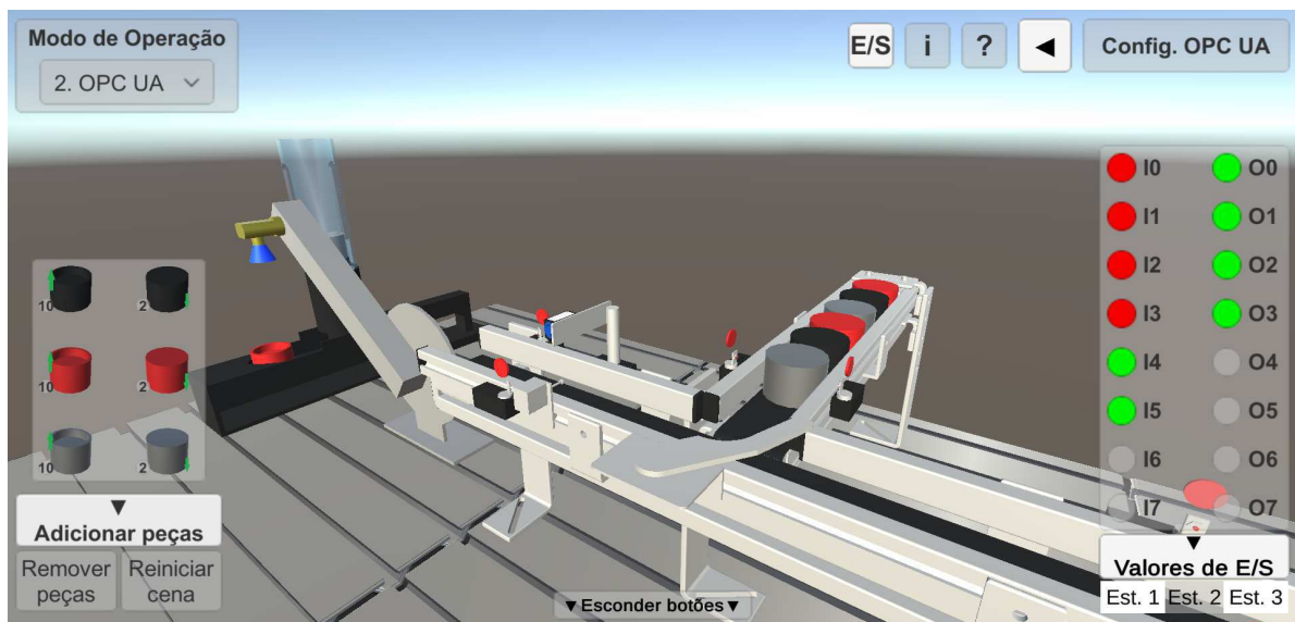
Figura 96 – Modo de operação conectado a um servidor OPC UA: estação de separação.
