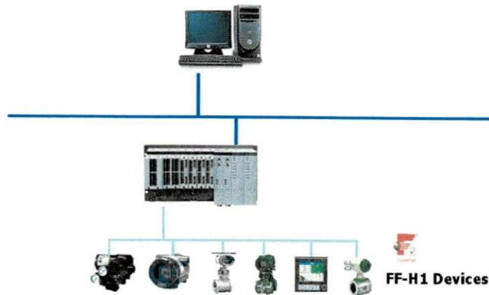
Figura 1.10 Exemplo de uma instalação Foundation Fieldbus
