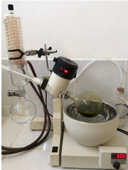
Figura 2.1: Evaporador rotativo utilizado nos ensaios de secagem.
