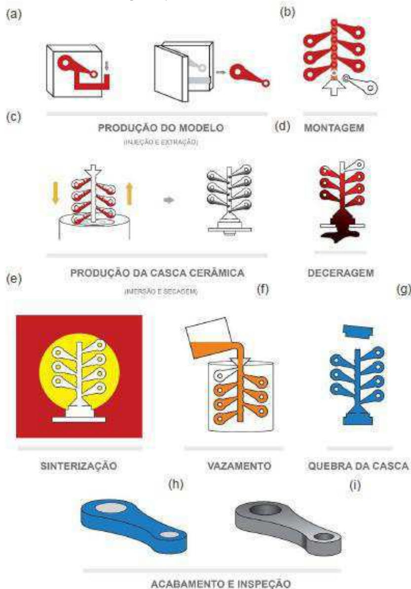
Figura 28 - Principais etapas do processo de fundição de precisão por molde tipo casca cerâmica para produção de biela automotiva
