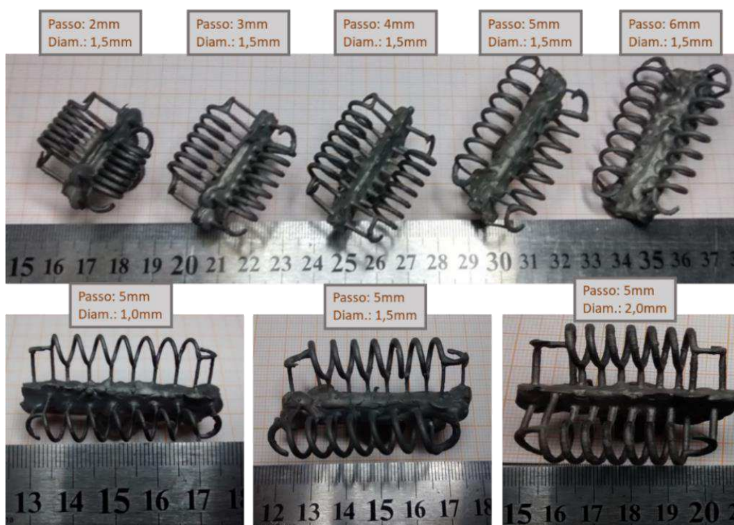
Figura 55 - As M_{LMF}NiTi obtidas pelo processo de fundição de precisão.
