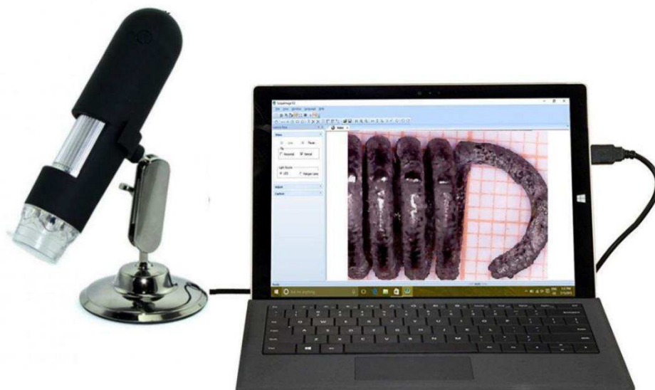
Figura 49- Inspeção visual no Microscópio digital.
