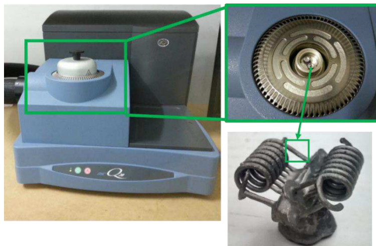
Figura 51 - Calorímetro DSC da TA Instruments modelo Q20, com detalhe do interior do equipamento e da região da mola que é retirada a amostra.
