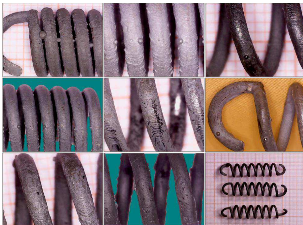
Figura 56 - Inspeção visual da superfície das Molas de LMF Ni-Ti
