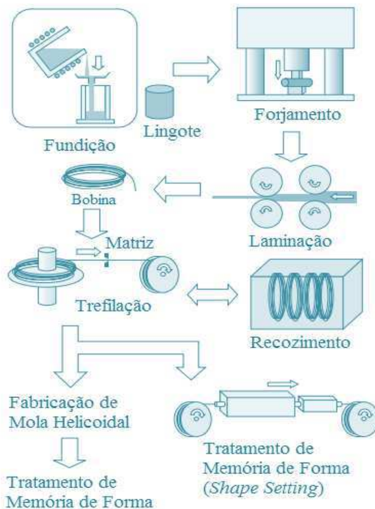
Figura 25 - Esquema de processos de fabricação de componentes de LMF Ni-Ti.
