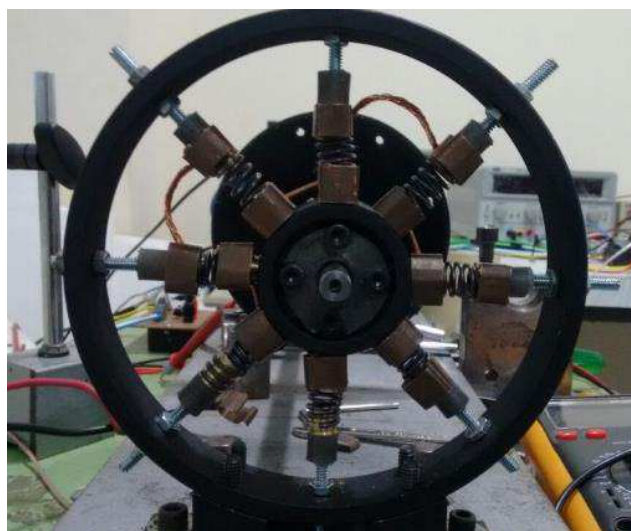
Figura 22 – Protótipo de mancal adaptativa com molas LMF.
