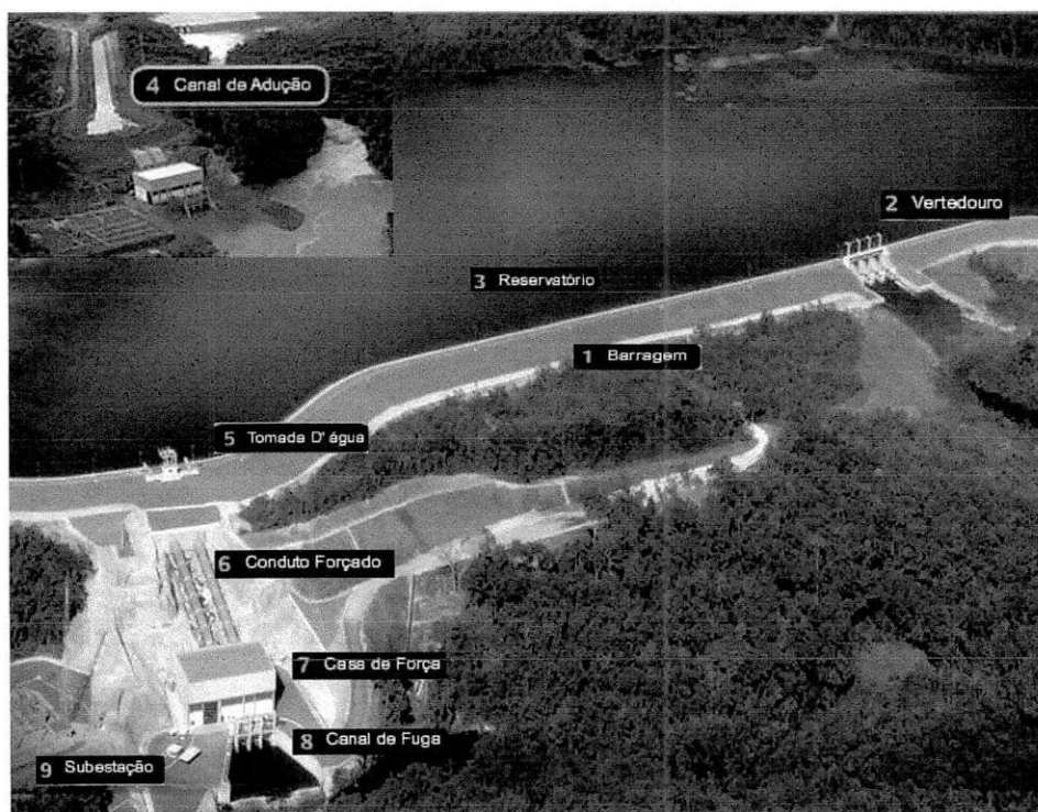
Figura 1: Composição de uma PCH (Atiaia energia, 2008. editado pelo autor).
