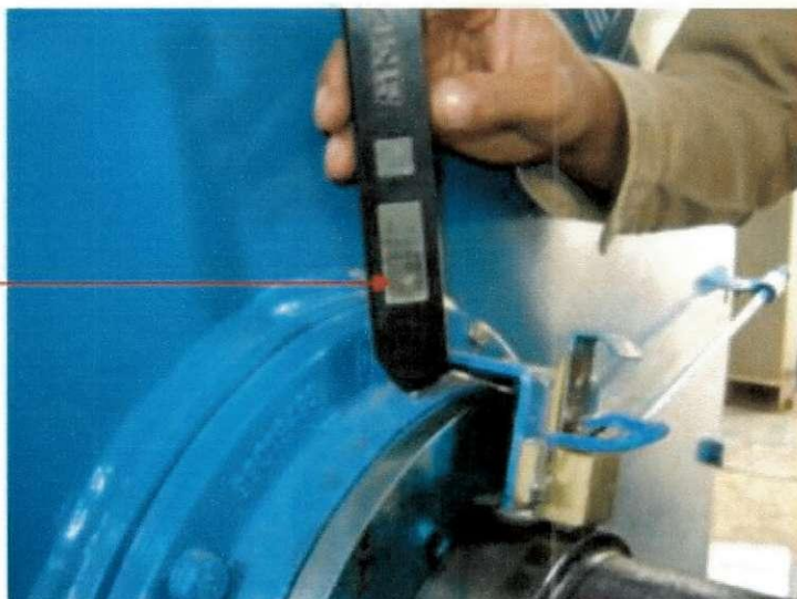
Figura 9: Medição do nível de vibração no mancal de um motor.
