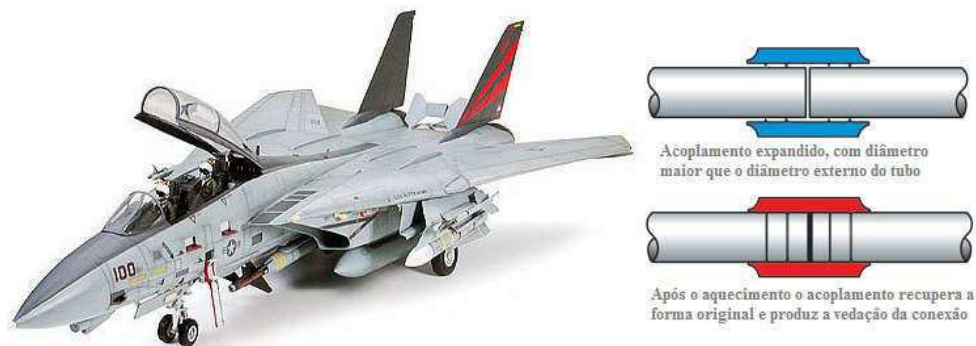
Figura 8 – Aplicação de uma LMF Ni-Ti em sistema de acoplamento de tubos - Caça Grumman F-14 Tomcat .
