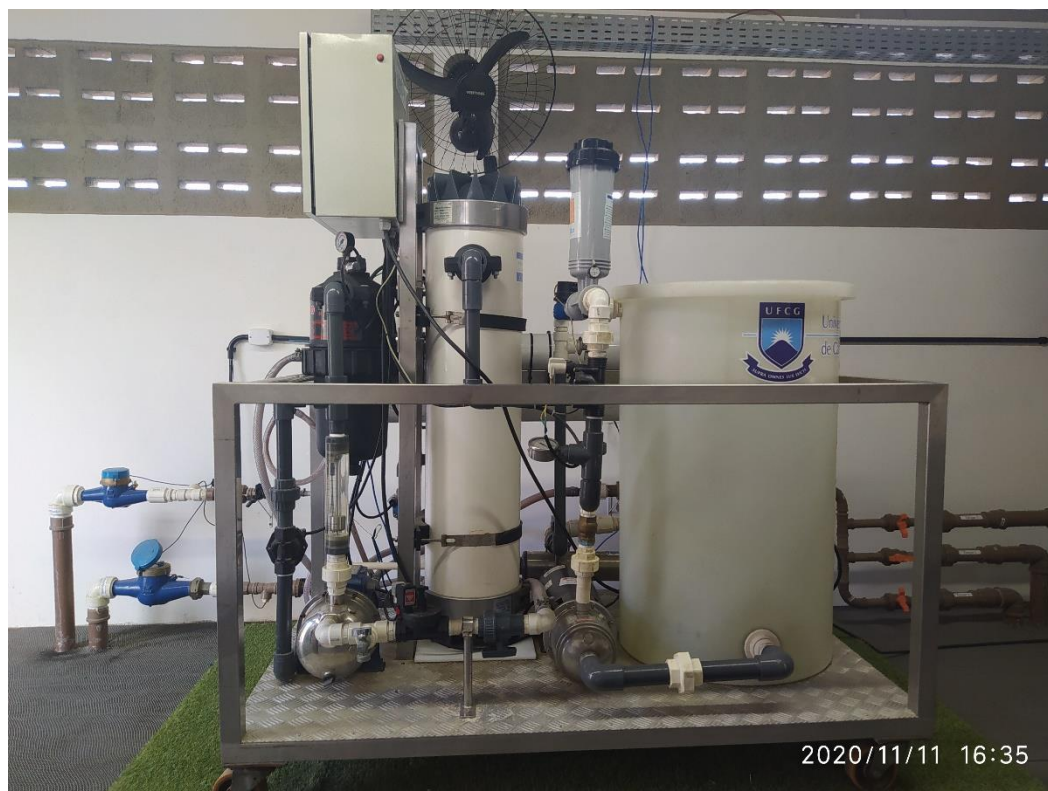
Figura 8. Sistema composto por ultrafiltração e osmose inversa
