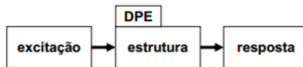
Figura 21 – Esquema de controle por dissipação passiva de energia (DPE).
