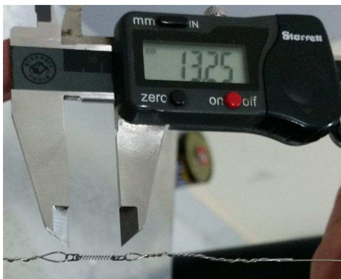
Figura 62 – Pré-tensionamento realizado na mola.
