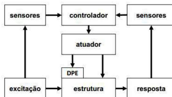
Figura 23 – Esquema de controle híbrido de vibrações.
