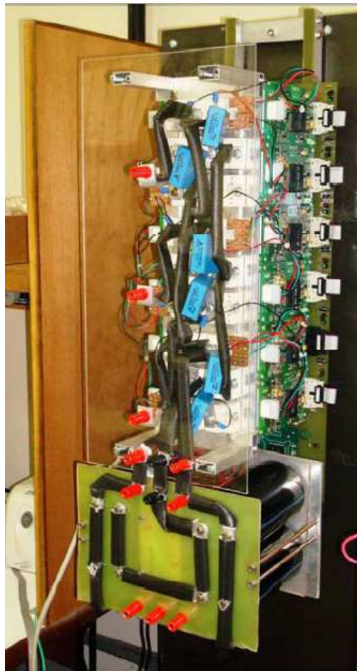
Fig. 4.17: Inversor Trifásico de Três Níveis com Diodos Grampeadores.
