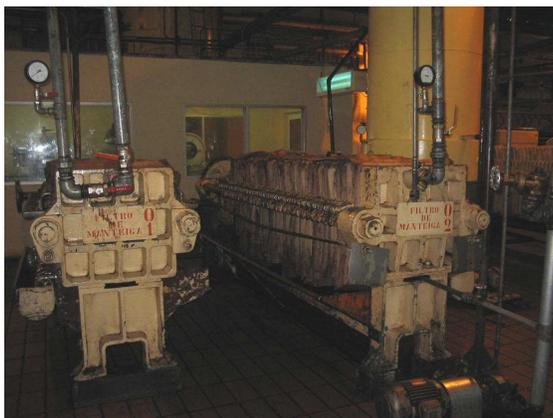
Figura 4.15: Filtros Horizontais de Manteiga de Cacau.
