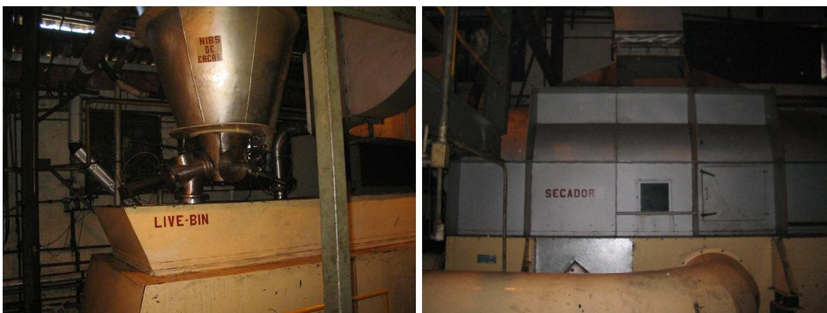
(a) Descarga do CONIMIX para a esteira Live-Bin. (b) Secador de *Nibs* (alimentado pela Live-Bin).
