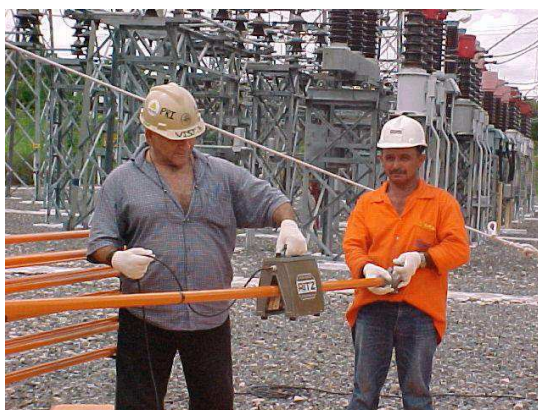
Figura 31 - Fotografia da Realização do Ensaio de Isolamento de Bastão Isolante.
