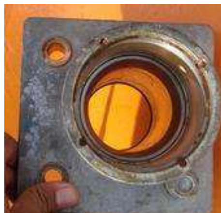
Figura 51 - Fotografia da parte interna do mancal após limpeza.
