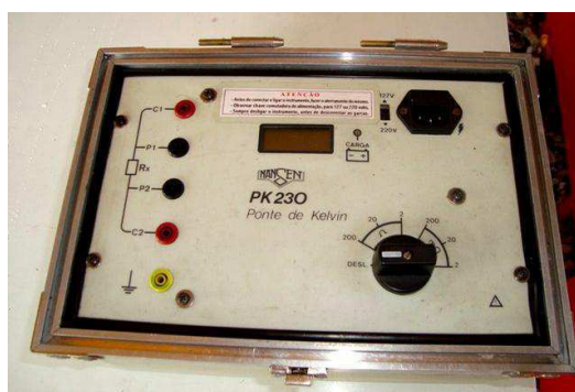
Figura 58 - Fotografia do Medidor de Resistência de Contato
