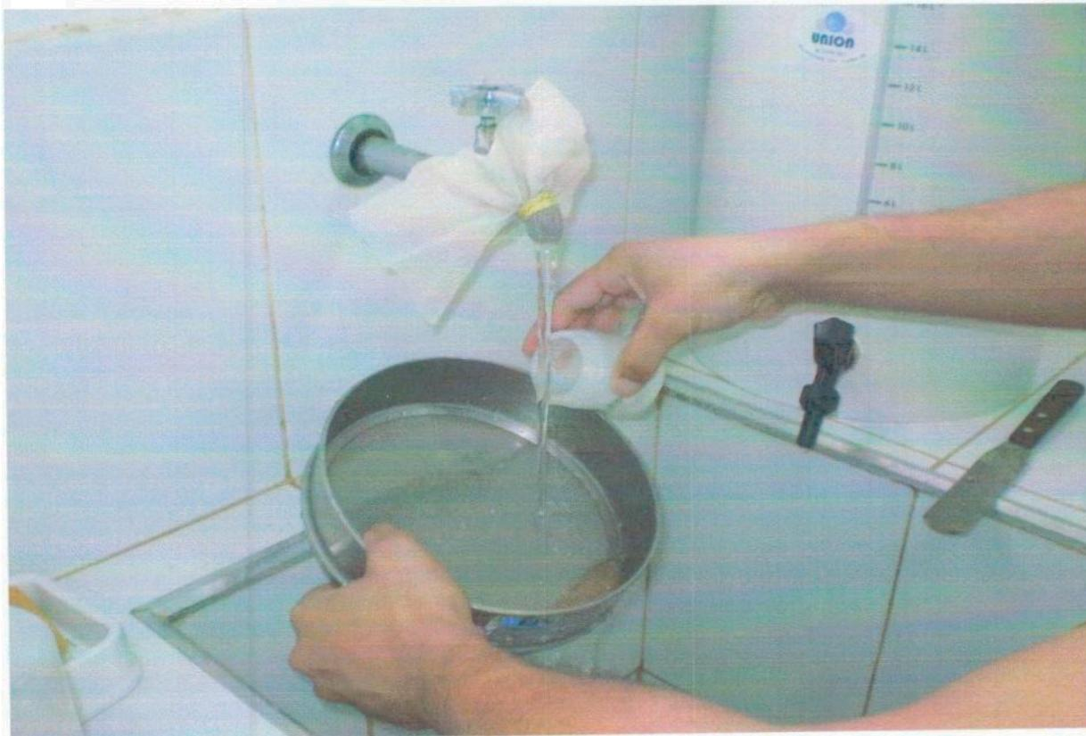
Figura 05: Peneiramento por via úmida.
