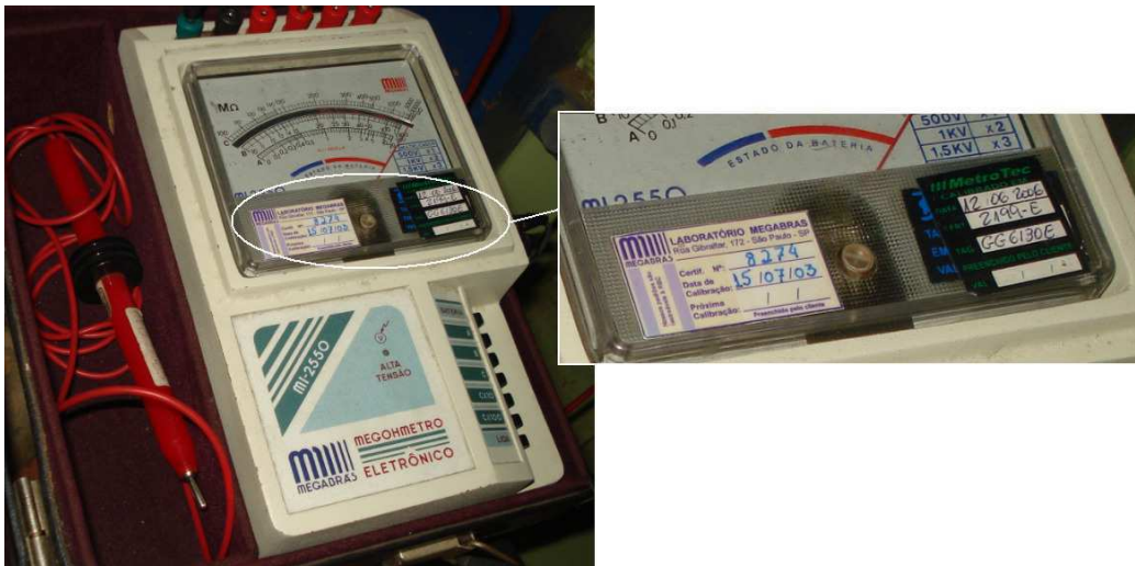
Figura 23 – Megômetro com calibração vencida.
