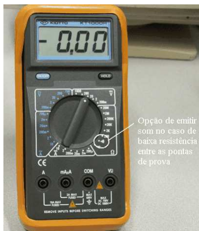
Figura 18 – Multímetro e opção de verificação de continuidade.
