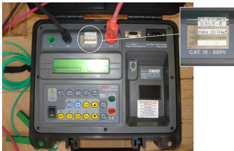
Figura 24 – Megômetro com calibração normalizada.
