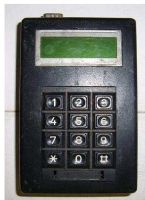
Figura 30 – Teclado de programação do Controlador da CONTRANSIN
