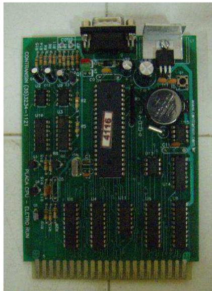
Figura 29 – Placa de Controle do Controlador da CONTRANSIN
