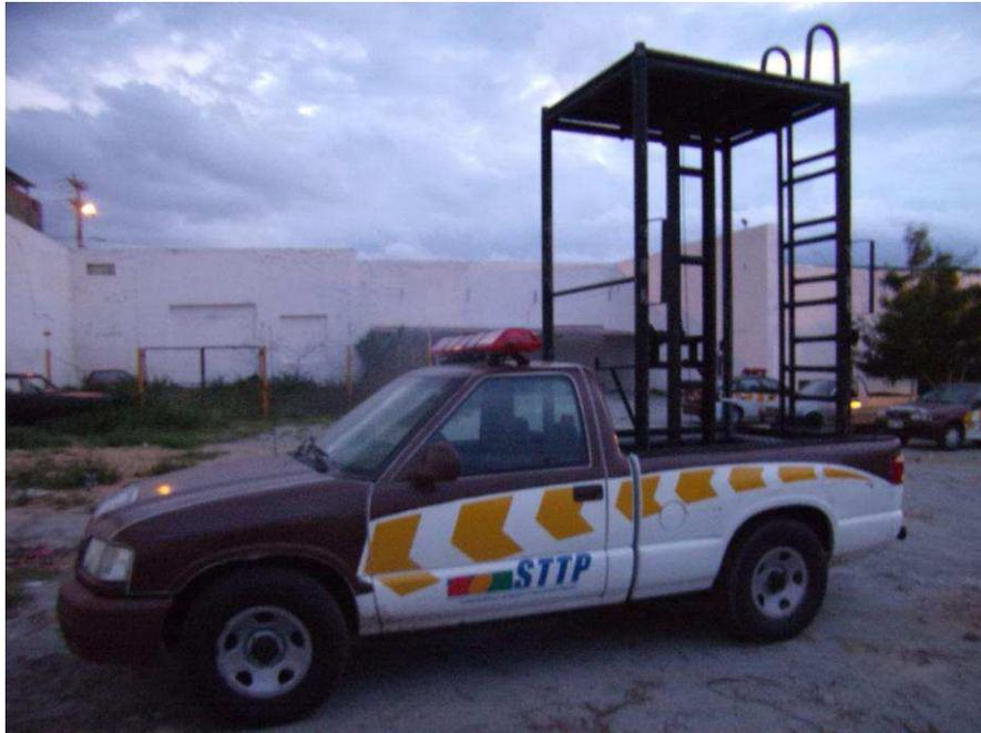
Figura 14 – Veículo utilizado na manutenção semafórica
