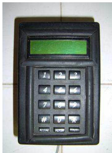
Figura 26 – Teclado de programação do Controlador da NEWTEC
