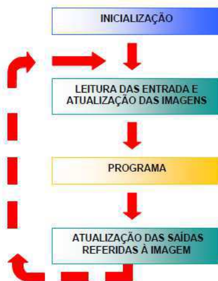
Figura 28 – Ciclo de processamento dos CLP's.
