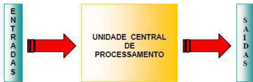
Figura 27 – Estrutura básica de um CLP.
