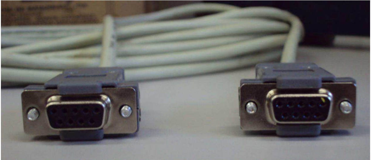
Figura 27 – Exemplo de cabo serial utilizado pela AD.
