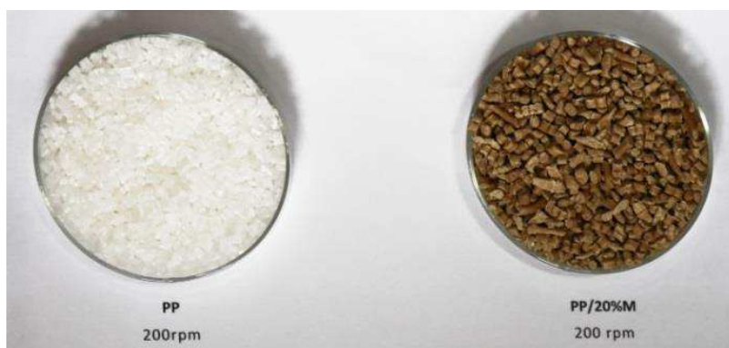
Figura 37 – Pellets de PP puro e do compósito PP/20% pó de madeira extrudados a 200 rpm.
