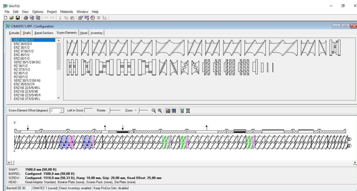
Figura 72 – Configuração do barril e da rosca da extrusora Berstorff ZE-30 na janela Configuration de WinTXS.
