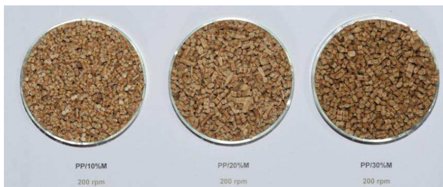
Figura 38 – Efeito do teor de carga na cor dos pellets do compósito PP/pó de madeira extrudados a 200 rpm.
