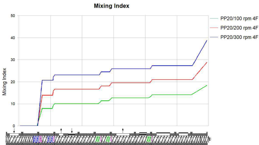
Figura 99 – Simulação do perfil do Índice de Mistura para o processamento de compósitos de PP com 20% de pó de madeira a diferentes velocidades de rotação.
