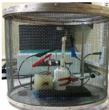
Figura 8 - Célula eletroquímica e Gaiola de Faraday para análise de corrosão.
