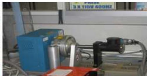
Motor mecânico e dinamômetro (azul)
