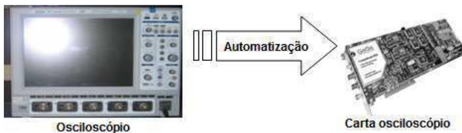
Figura 4.21 – Automatização do osciloscópio por uma carta osciloscópio para PCI
