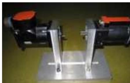
Figura 4.32 – Suporte com dois motores em vazio
