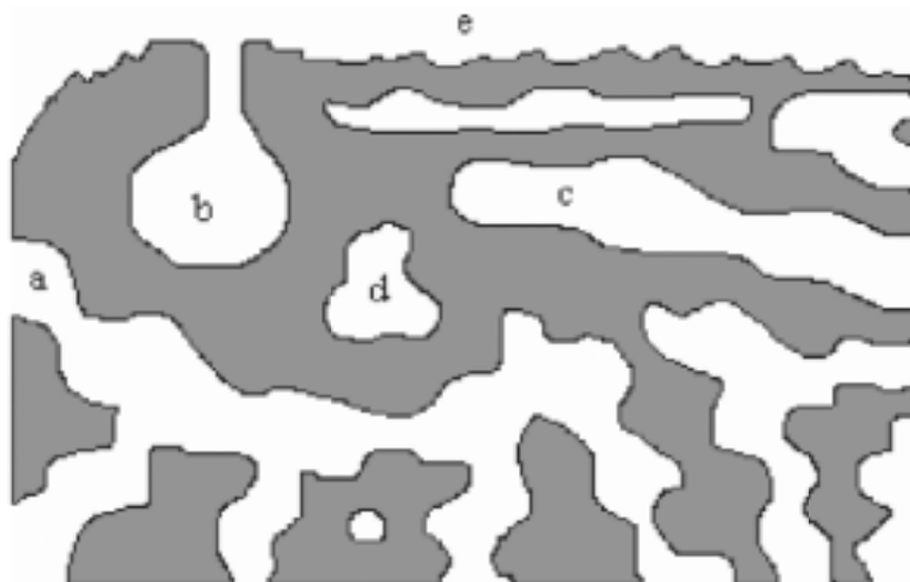
Figura 2.2 – Esquema ilustrativo de um sólido poroso com diferentes tipos de poros: abertos (a), (b) e (c), fechado (d) e extremidade da superfície (e) (Ferreira e Alves, 2007).
