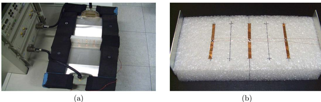
Figura 2.16: Caracterização de uma SSF com um guia de ondas de placas paralelas. (a) Guia de placas paralelas; (b) SSF no interior do guia. Figuras extraídas de [1].
