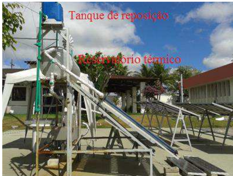
Figura 3.5 – Reservatório térmico do secador solar
