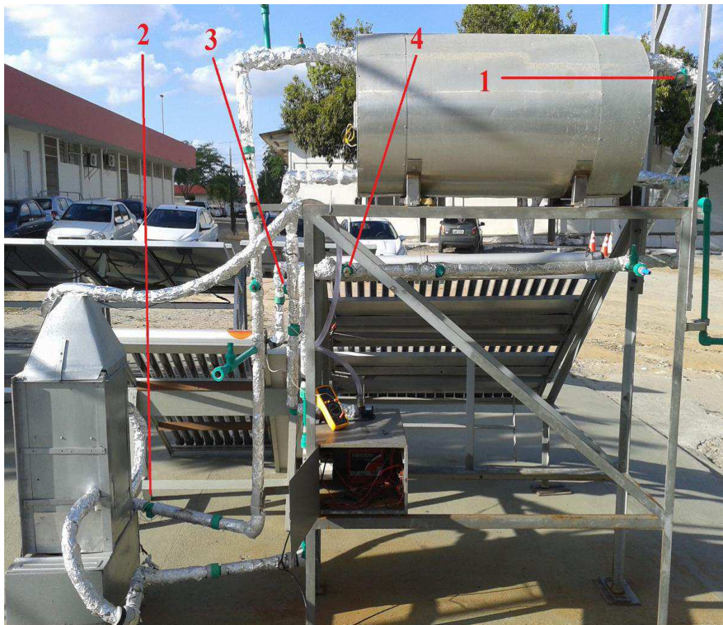
Figura 3.8 – Localização dos sensores de temperatura no secador ACSN: 1 – Sensor de saída de água quente do coletor a vácuo; 2 – Sensor de entrada de água quente da câmara de secagem; 3 – Sensor de entrada de água fria do coletor a vácuo; 4 – Sensor de saída de água quente da câmara de secagem; e, 5 - Sensor de temperatura no interior da câmara de secagem
