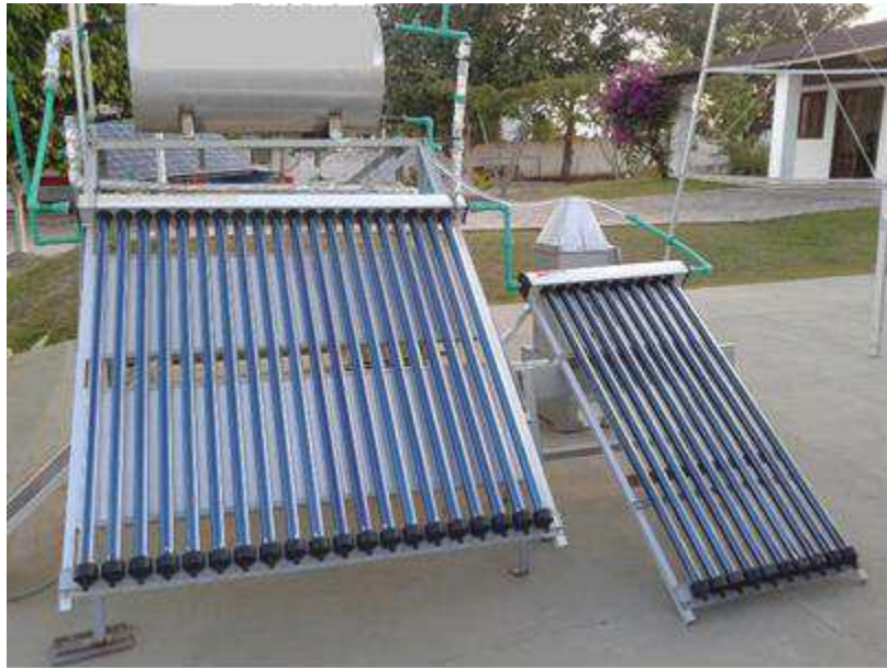
Figura 3.3 – Coletores solares de tubos a vácuo tipo U-tube de vinte e dez tubos
