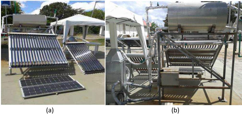
Figura 3.2 – Vista frontal (a) e vista posterior do Secador Acumulador de calor para secagem noturna (ACSN) (b)
