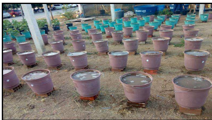
Figura 3. Lisímetros de drenagem com umidade do solo na condição de saturação.
