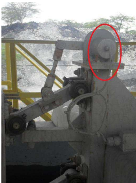
Figura 26 – Foto do encoder associado ao braço da boia.
