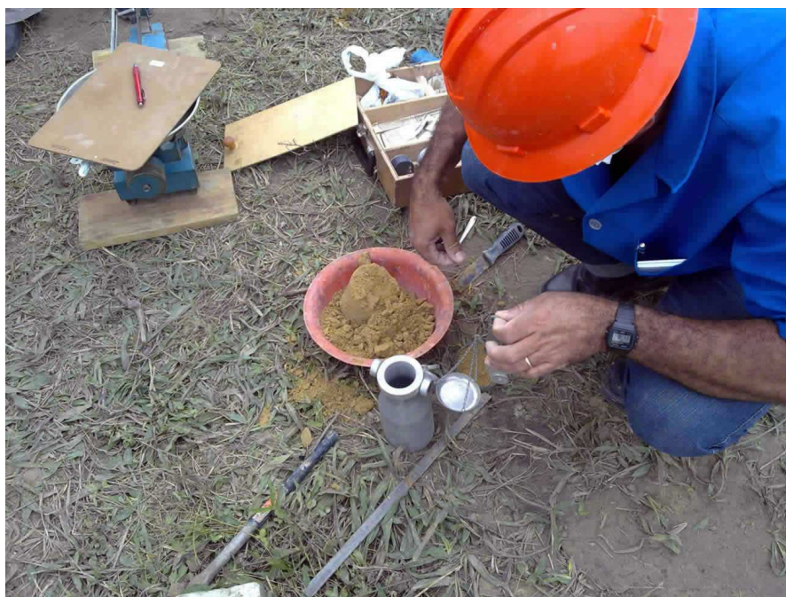
Figura 1.7: Realização de ensaio de densidade de solo para determinação de resistência à carga.
