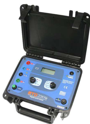
Figura 1.8: Terrômetro MTD-20KWe - utilizado para medição de resistência de aterramento.
