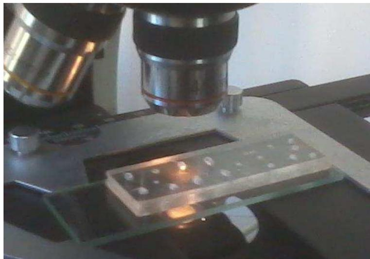
**Figura 12** Amostra em observação no microscópio óptico. Vários canais foram feitos em cada amostra de PMMA, que podem ser identificados nesta imagem pelas marcas mais claras com relação ao fundo mais escuro em que a amostra se encontra.
