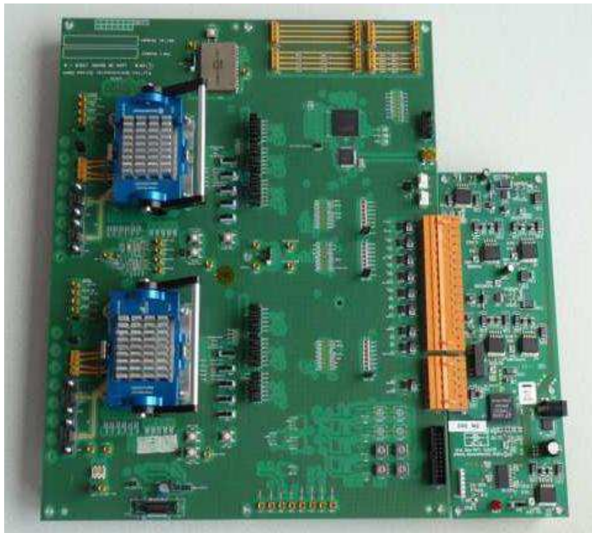
Figura 22: Conexão entre as placas de alimentação e avaliação.
