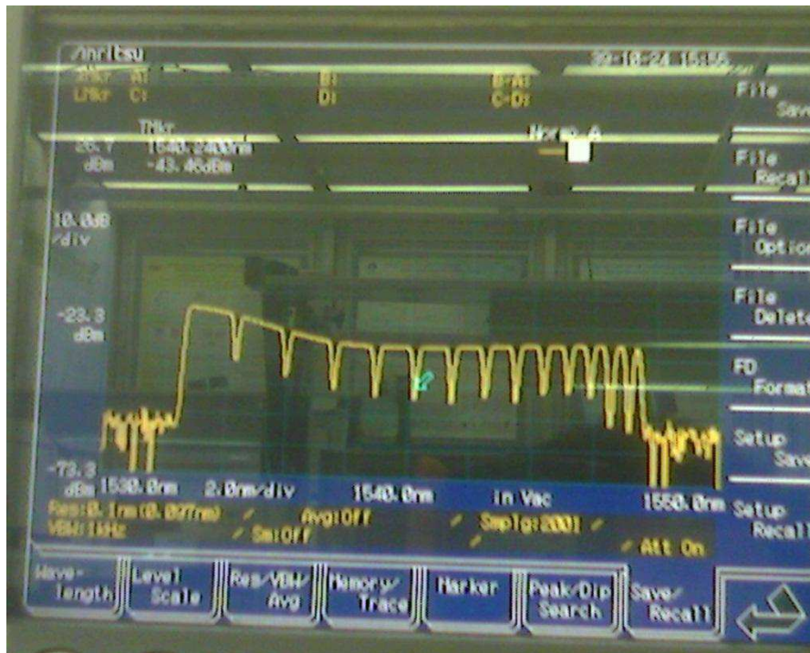
Figura 53: Espectro de saída da Porta Comum observado no OSA.
