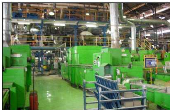
Figura 11- Linha de Empastamento e secagem. Fonte: [8].
