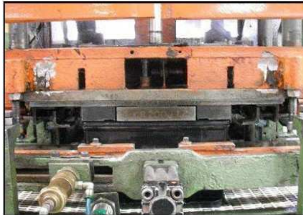
Figura 16- Molde utilizado na Seladora para Selagem Caixa/Tampa. Fonte: [8].
