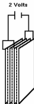
Figura 5-Circuito elétrico de uma célula com várias placas ligadas em paralelo. Fonte: [1].
