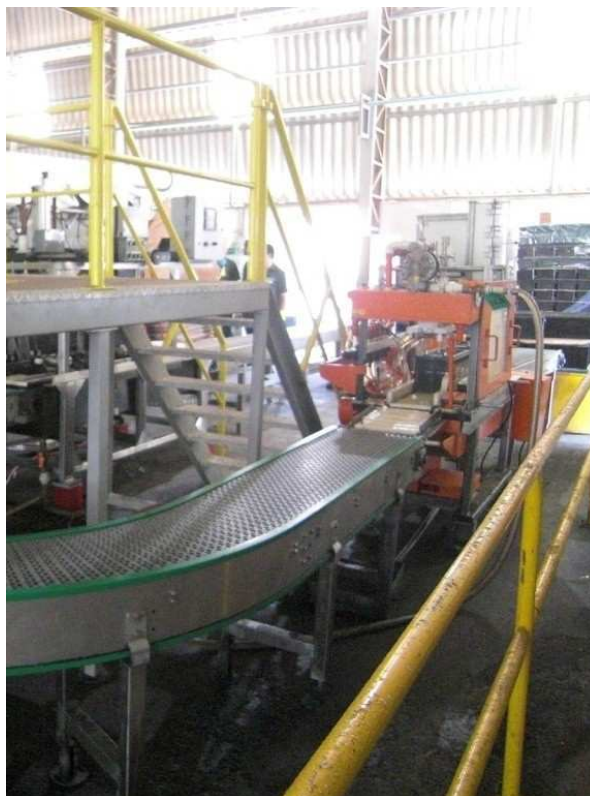
Figura 18- Sistema Transportador de baterias com MEN fixa.
