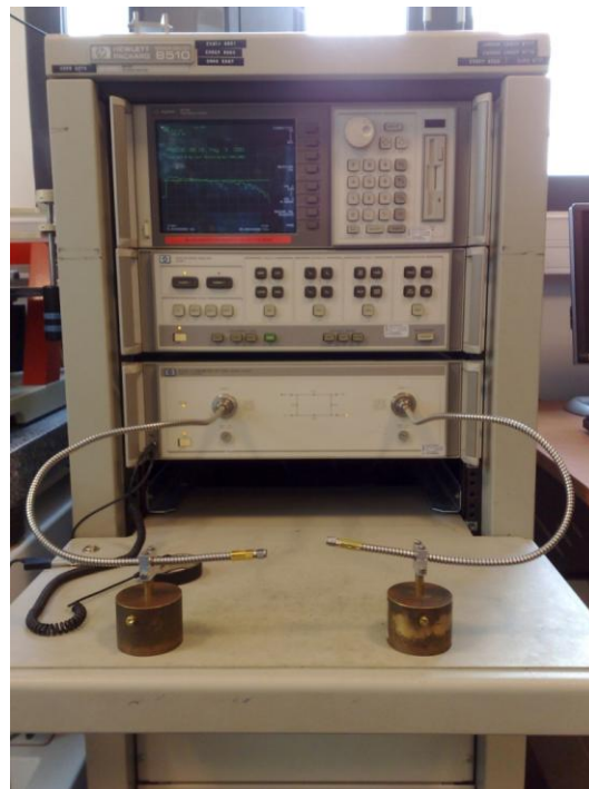
Figura 20 – Bancada de medição composta por um VNA 8510C da Agilent.
