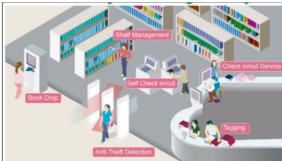
Figura 23 – Exemplo de um Sistema RFID para uma biblioteca (Foulk, 2010).
