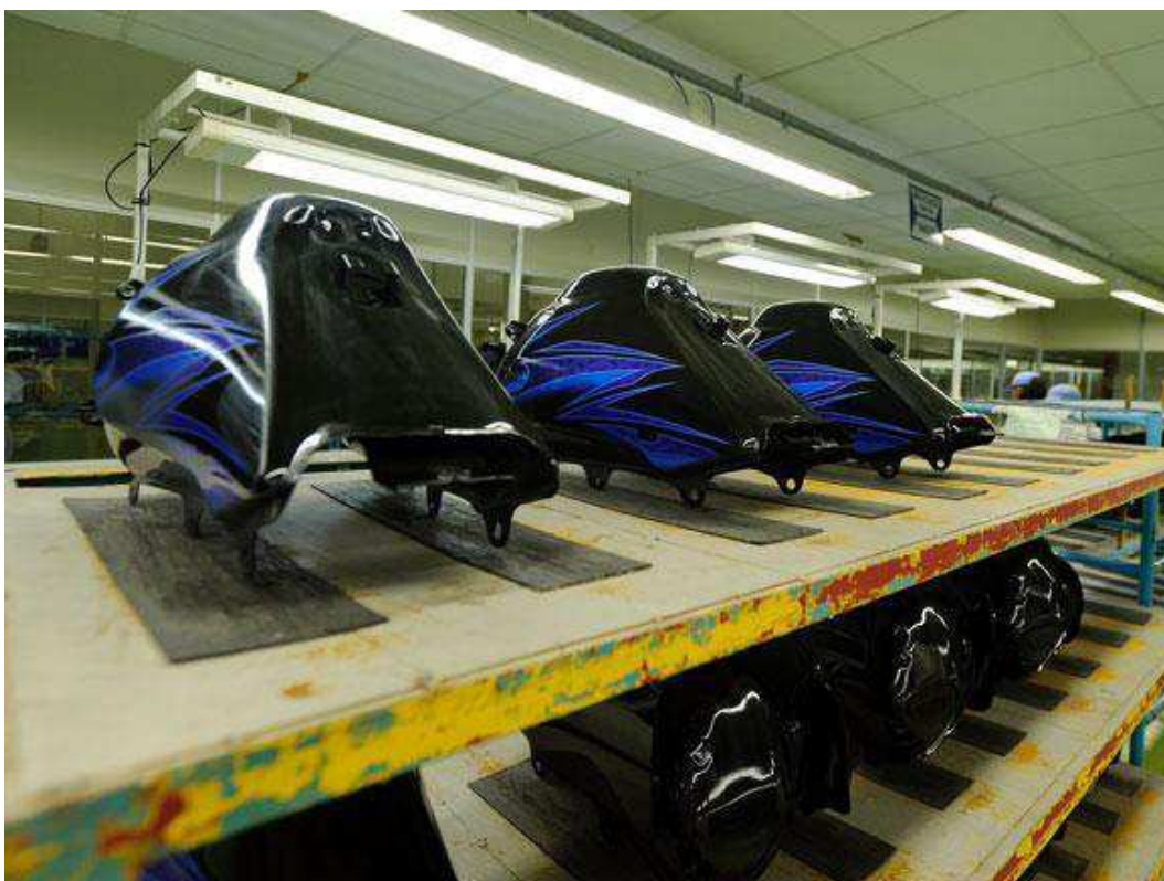
Figura 7: Tanques após o acabamento final de pintura
