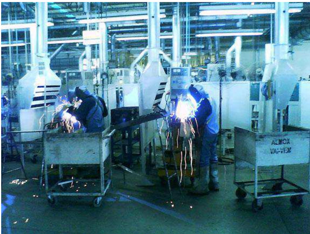
Figura 6: Colaboradores trabalhando na solda do chassi
